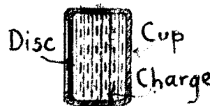
Fig 1-34 TYPICAL STAB FUZE PRIMER
